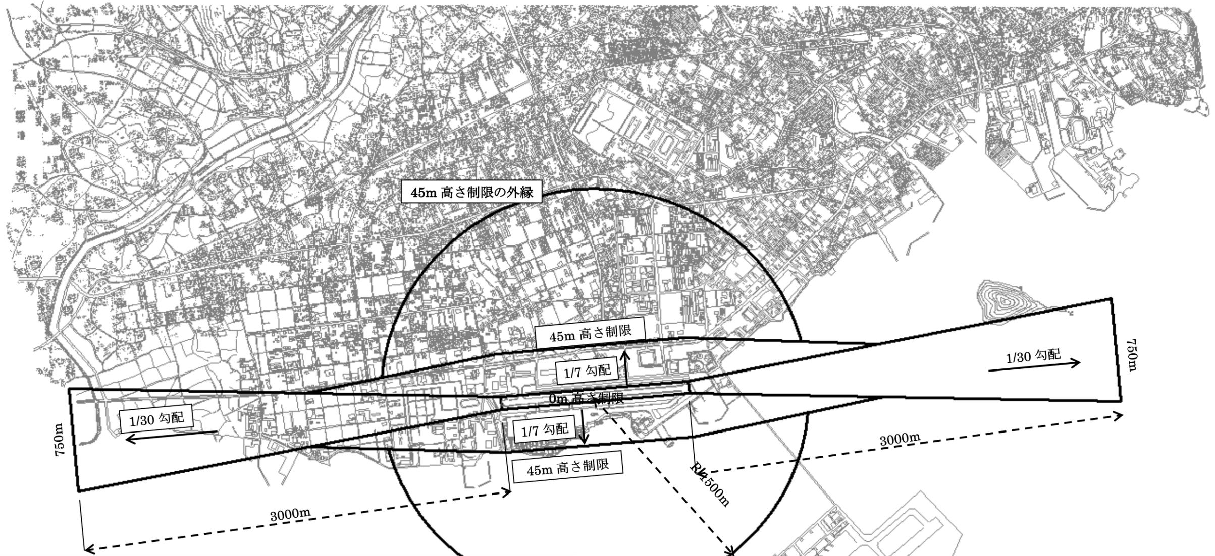
飛行場周辺は、航空機が安全に離発着できるように障害物がない状態にしておく必要があり、建造物の設置等が制限されます。(航空法第49条)
