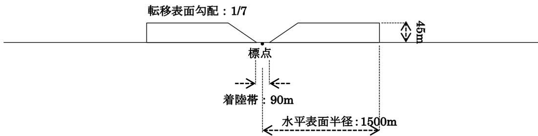
大村飛行場制限表面の断面概略図 (短側面)
