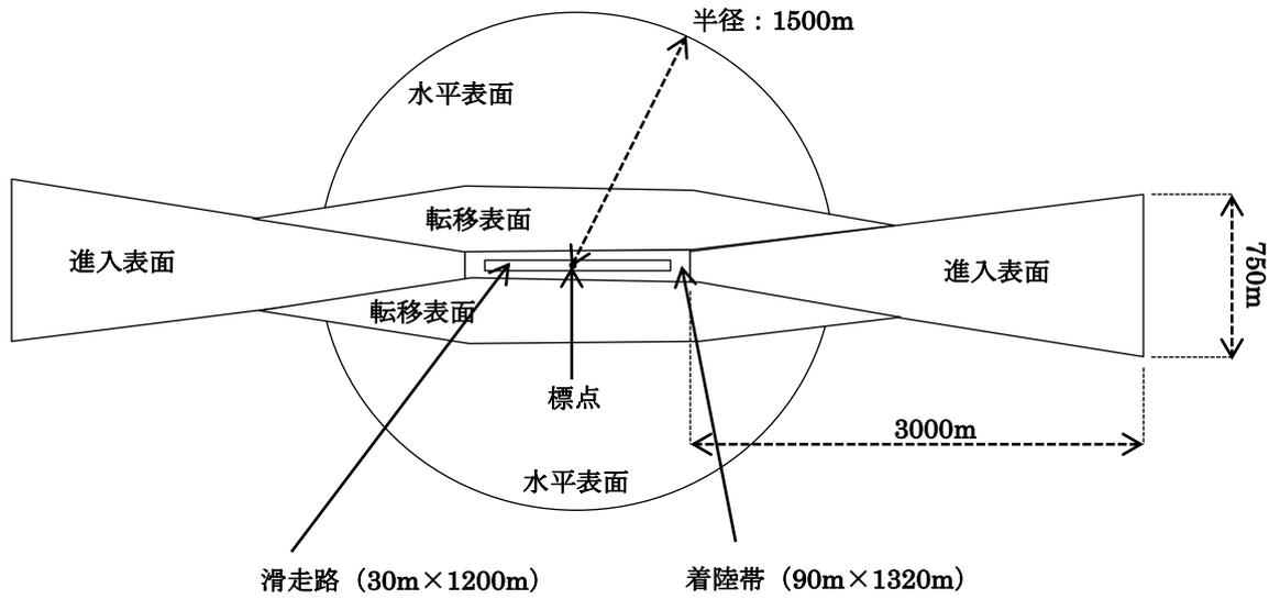
大村飛行場制限表面の平面概略図
