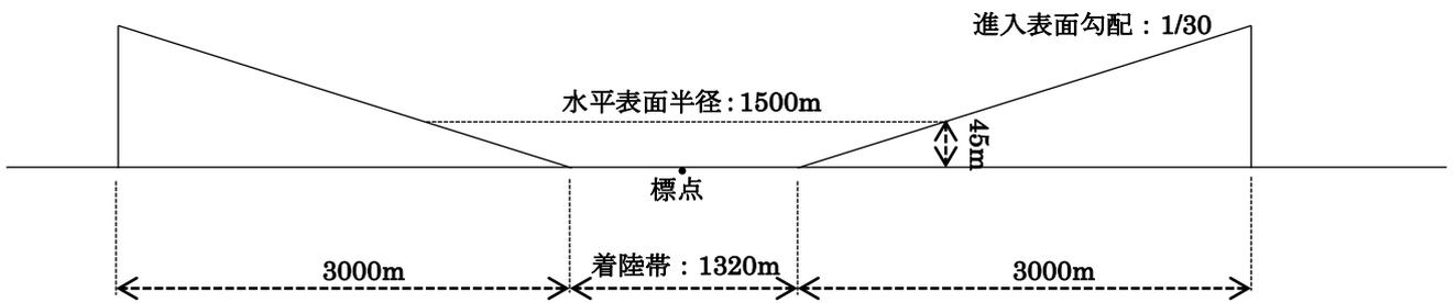
大村飛行場制限表面の断面概略図 (長側面)
