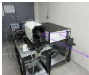
小型ラマン遠隔計測システムの原理検証用試作機の例
