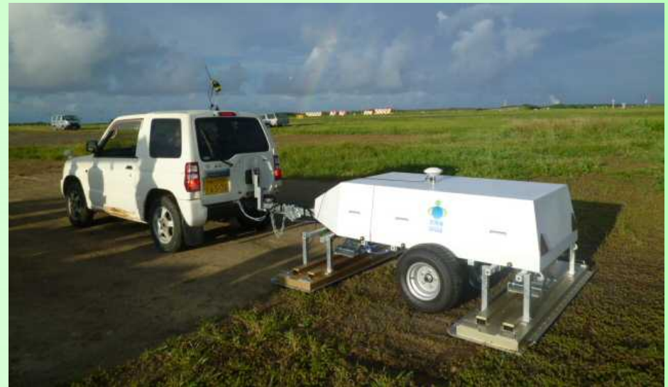
壕等を地表から探査する手法の検討 (写真は硫黄島において実施した高性能地中レーダ 試作機の性能確認試験の状況)
