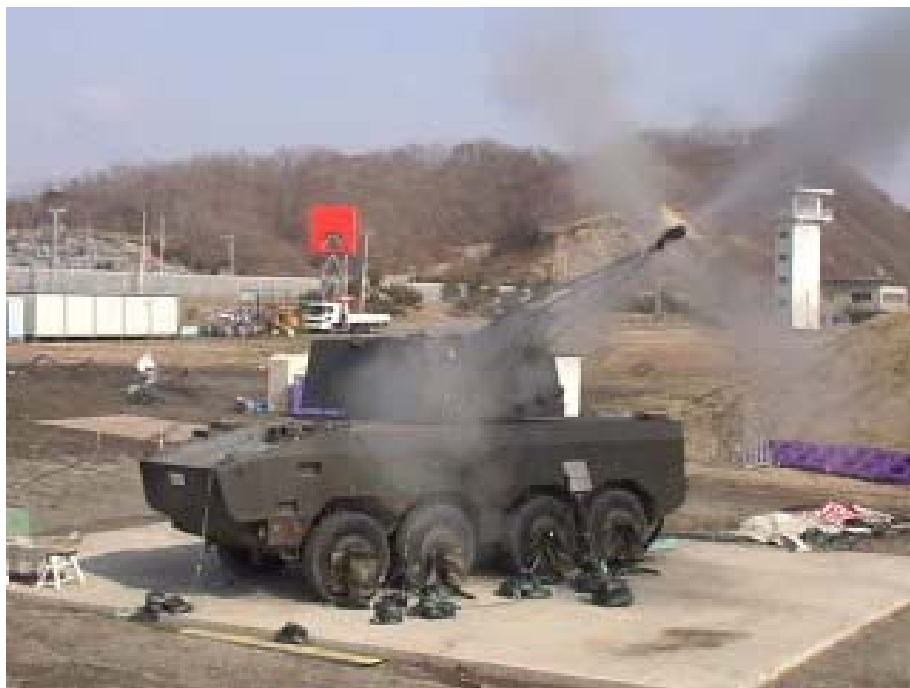
40mmCTA機関砲の連続射撃試験
