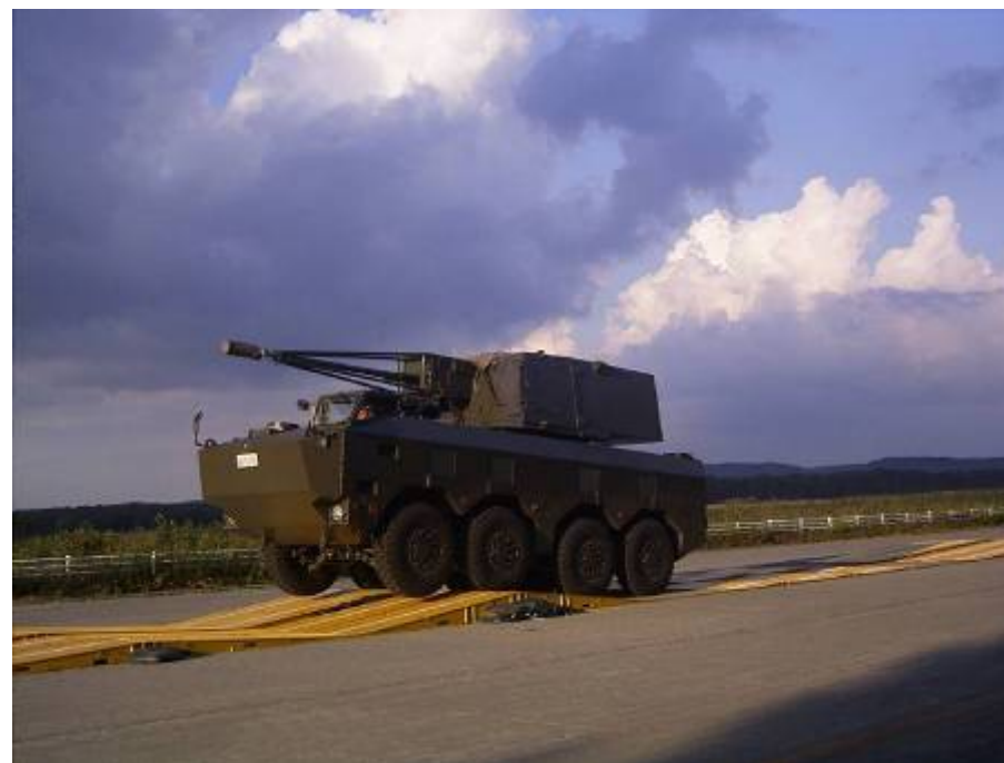
障害版を使った路外機動試験
