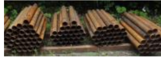
ボーリングに使用するケーシング例
