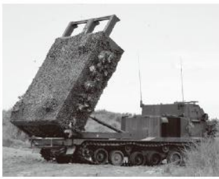
地対艦ミサイル連隊との連携射撃の態勢を整えるMLRS自走発射機
