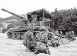
二〇三mm自走榴弾砲の射撃準備を完了し射撃開始を待つ隊員
