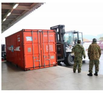
大型フォークリフトによるコンテナの搬入
