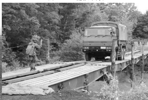
自走架柱橋を部隊が通過 (第312施設器材中隊)
