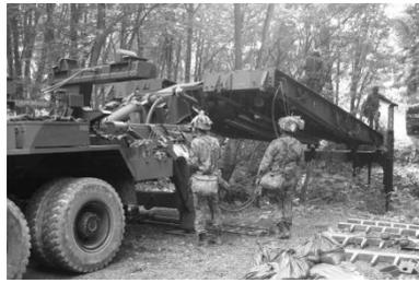
新たな任務を受け自走架柱橋を撤収(第312施設器材中隊)
