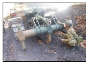
リッパーの点検及び整備
