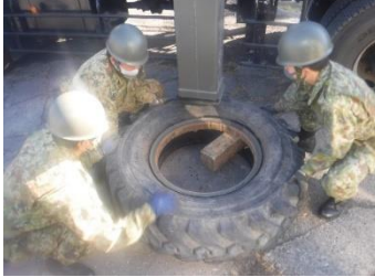
グレーダパンク修理
