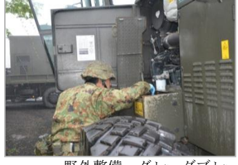
野外整備 グレーダブレーキバルブインナーキット交換
