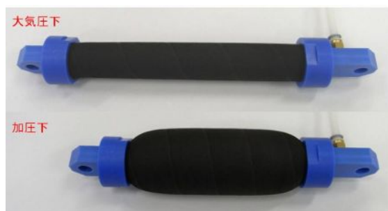
図1 空気圧ゴム人工筋
