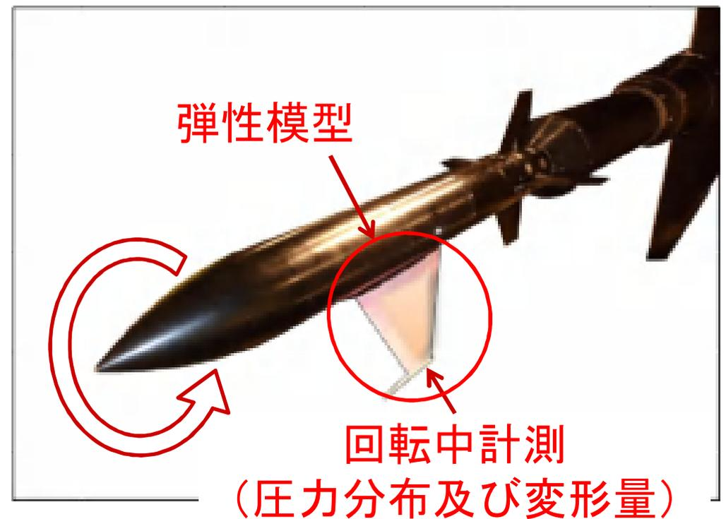
空力弾性風洞試験模型
