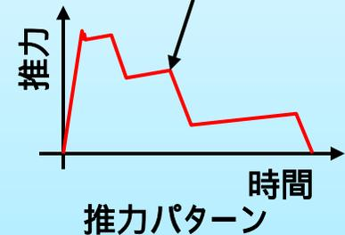
推進薬形状と燃焼速度の組み合わせで推力パターンをコントロール
