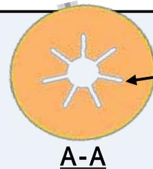
推進薬の光芒により燃焼面積を変更し、推力パターンを調整
