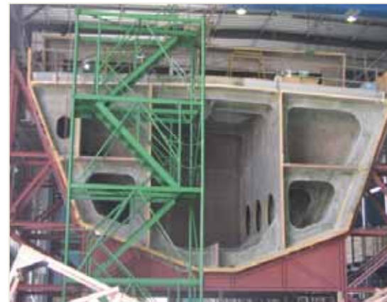
GFRPサンドイッチ構造
