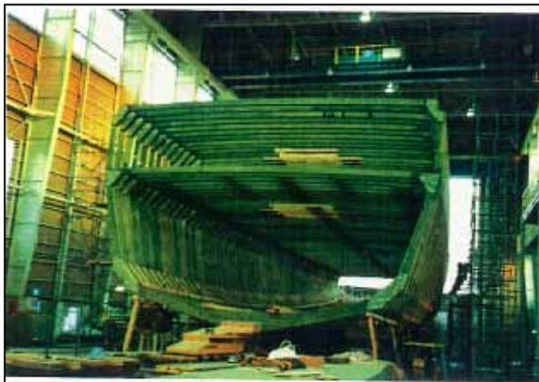
GFRPサンドイッチ構造
