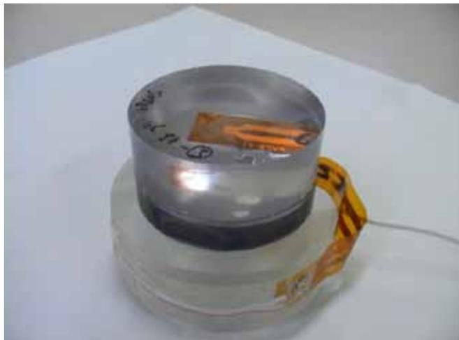
ゲージ方式の供試品設置例
