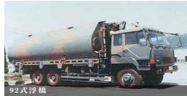
92式浮橋の専用運搬車
