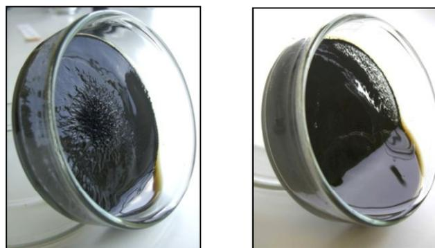
(図2 磁気粘性流体：(左) 磁石により磁場を印加、(右) 磁場なし)
