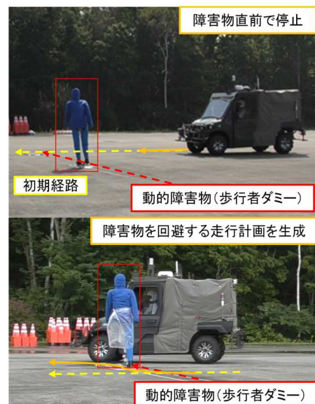
図2 動的障害物の回避(停止/回避機動)
