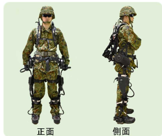
図1 高機動パワードスーツを装着した際の外観
