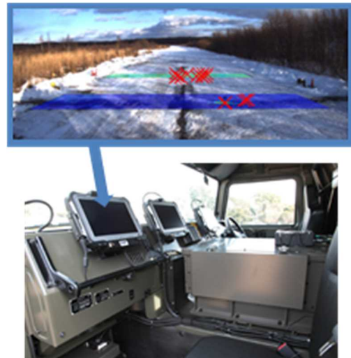
図 2 統合表示機能（上）統合表示結果の例（下）試作品操縦席モニタ
