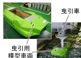
図2 模型車両及びその水槽試験の状況
