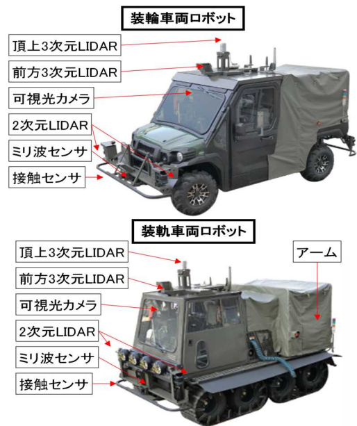
図1 多目的自律走行ロボットの概要
