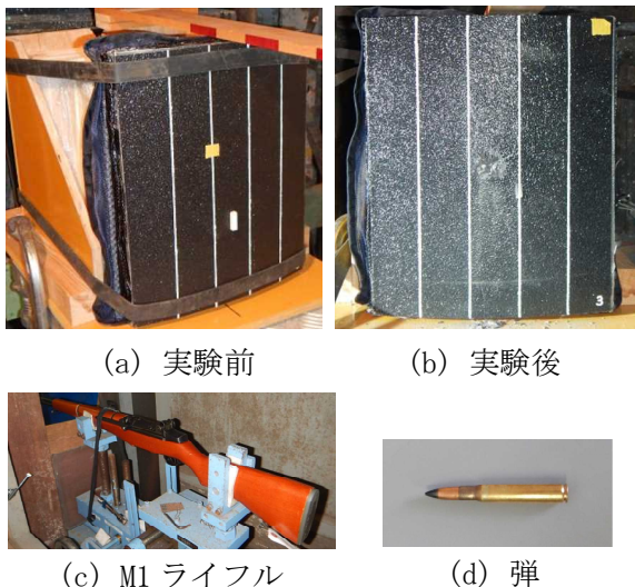
図1 耐弾プレートの衝突実験例
