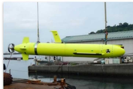
図2 USVと協調制御を行ったUUV
