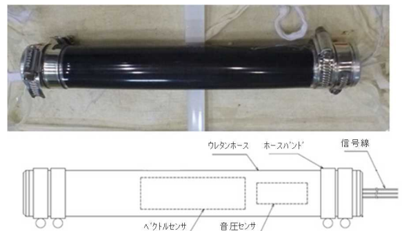
図2 方位検出型音響センサ 外観写真及び概要図
