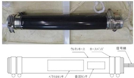
図2 方位検出型音響センサ
