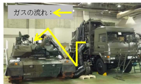
図2 装甲車両内部の除染
