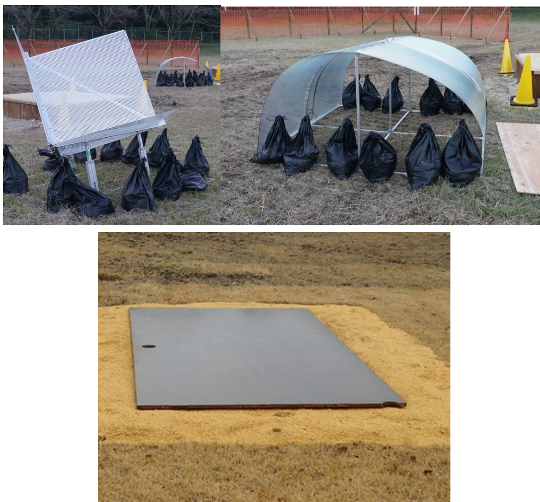
図3.62 製作・準備した供試体。（左上）1.2 m 正方形コーナリフレクタ、（右上）パイプ状散乱体、（下）敷鉄板。
