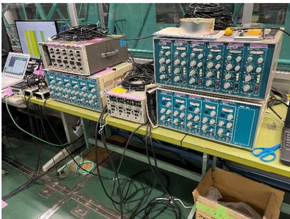
図3.3.1.10 半導体ひずみゲージ式せん断応力計用ひずみアンプ
