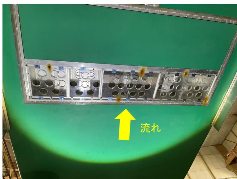
図3.3.1.2 50m長尺平板模型空気吹出部
