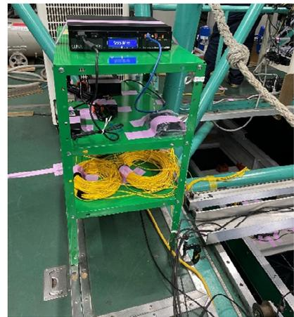
図3.3.1.11 FBGせん断応力計用光インタロゲータ
