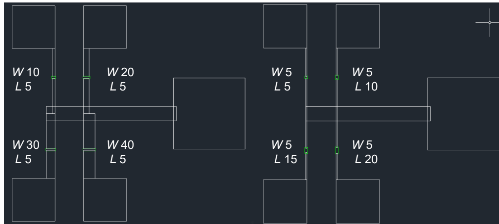
図 3-1-4-3 素子内グラフェンチャンネル幅 (W) と長さ (L) の設定。図中数値の単位 : \mu\text{m} 。
