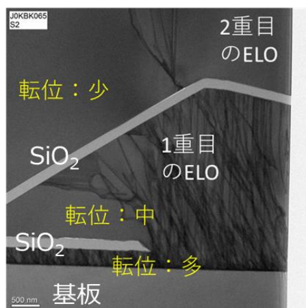
図 1-23 多重 ELO で積層させた \alpha -Ga 2 O 3 膜の断面 TEM 像
