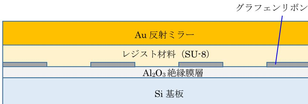
図⑧-B58 試作したグラフェンリボン+キャビティ試料の構造
