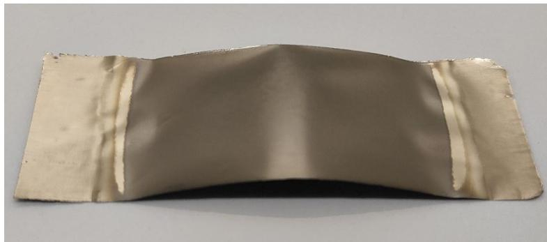
図②-26 研磨したニッケル箔基材にプラズマ CVD で合成した多層グラフェン.
