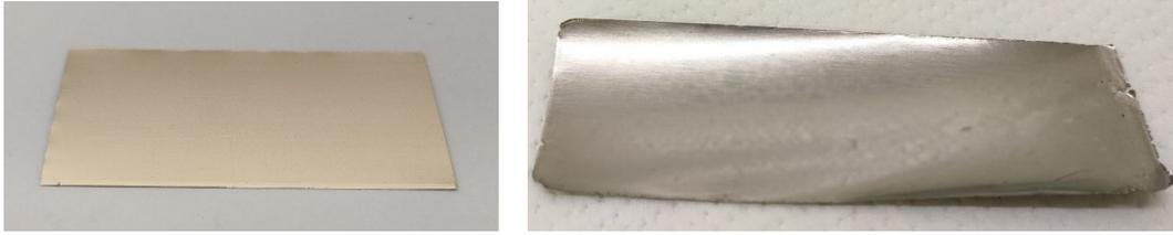
図②-25 研磨前(左)および研磨後(右)のNi箔. 研磨前の表面粗さ $\sim 1\mu\text{m}$ 、研磨後の表面粗さ $\sim 20\text{nm}$ .
