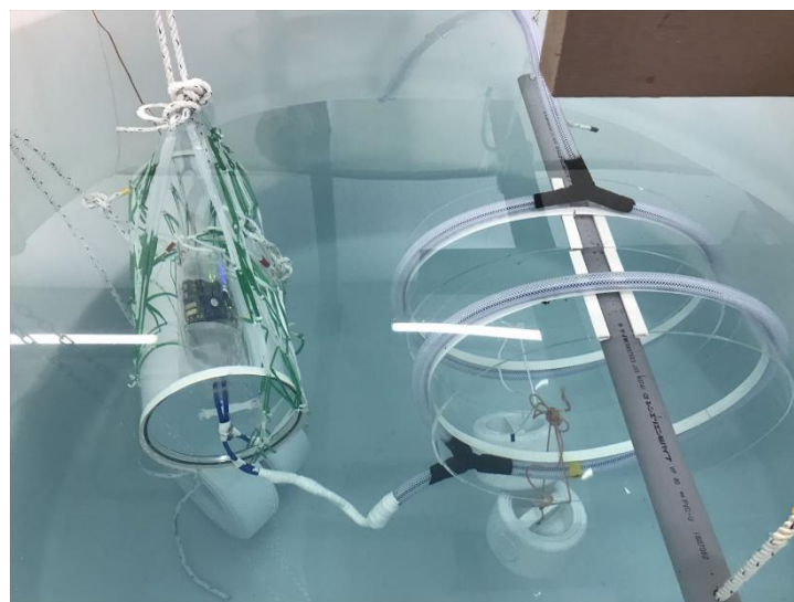
図 3.5-51 実験の様子 (左) 防水収納容器 (右) 送受電アンテナ
