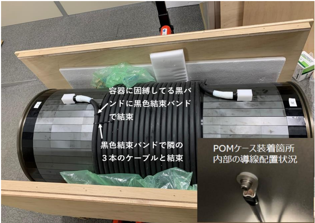
図 3.4-171 主耐圧容器 POM ケース取付け・受電コイル取り込み固定状態
