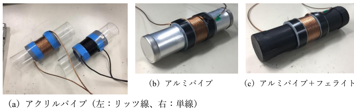
図 3.3-4 試作した受電コイルの外観
