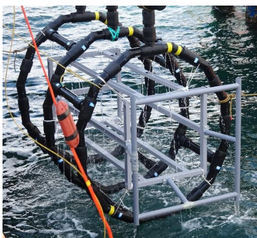
図 3.4-252 海中充電実験での AUV ガイドフレーム
