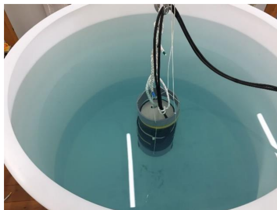
(b) 水槽中の受電コイル
