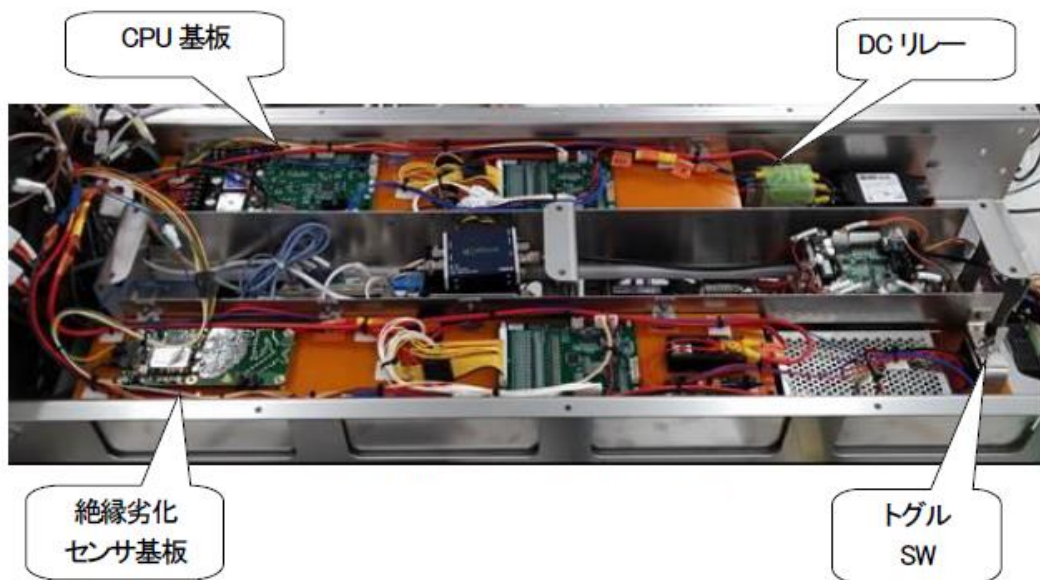
図 3.4-91 急速充電電池 AUV 搭載写真
