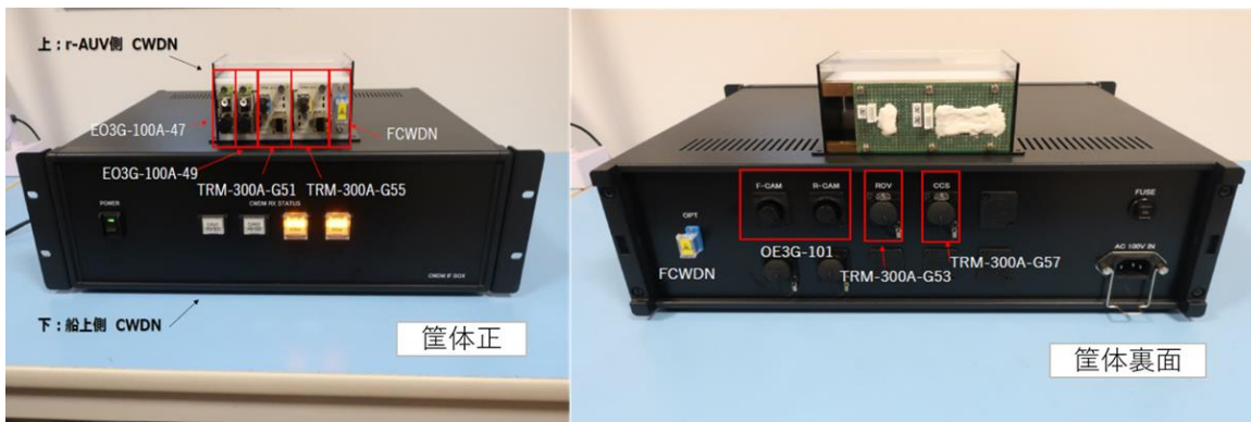
図 3.4-156 光通信装置 (粗波長分割多重 (CWDM) 通信装置)
