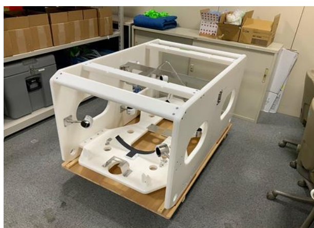
図 3.4-172 r-AUV 機体フレーム組立
