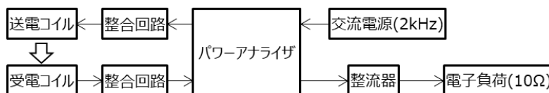
図 3.3-47 3 kW 対応した 2 分の 1 モデル実験システムのブロック図
