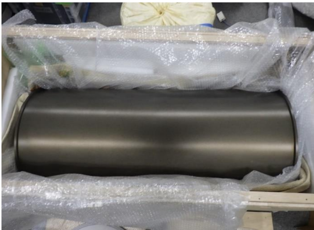
図 3.4-170 主耐圧容器胴部（フェライト貼り付け前）
