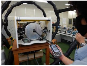
(a) 前蓋 15mm での 振動測定の様子
