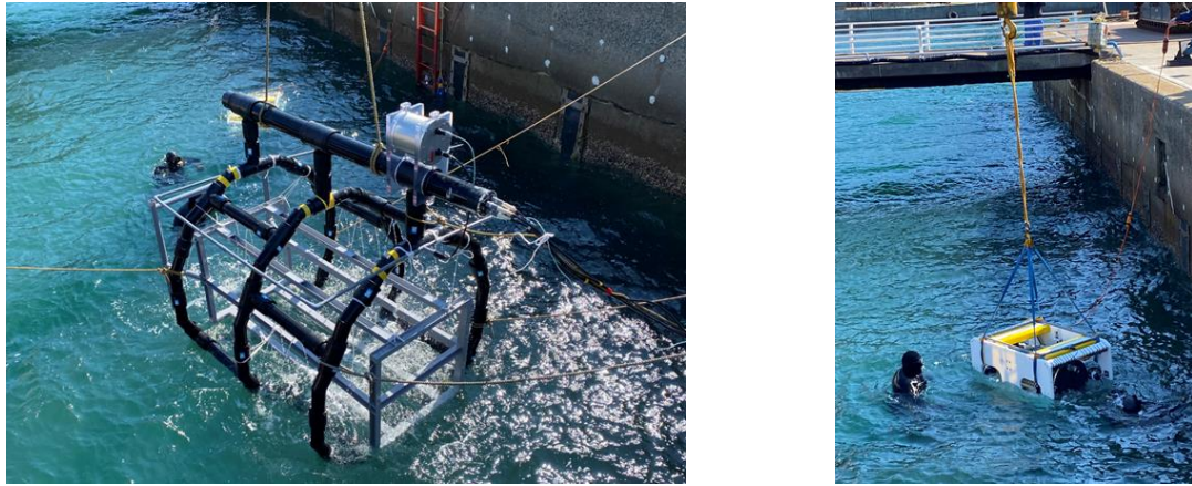
図 3.5-98 充電スタンドと AUV の海中への投入
