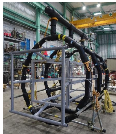
(b) AUV ガイドフレーム (3連給電コイル内に設置)
