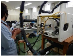
(a) 後蓋板厚 15mm での振動測定の様子
