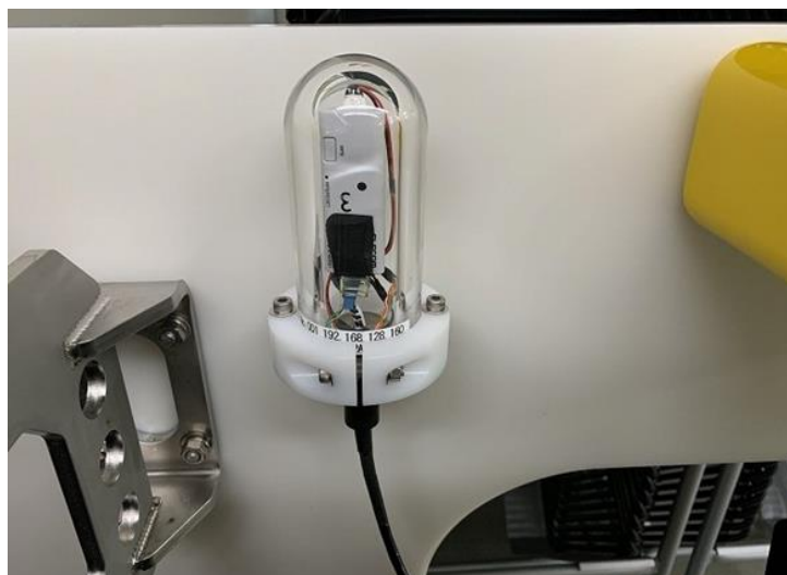
図 3.4-194 近距離通信装置（無線 LAN 水中部）搭載状況
