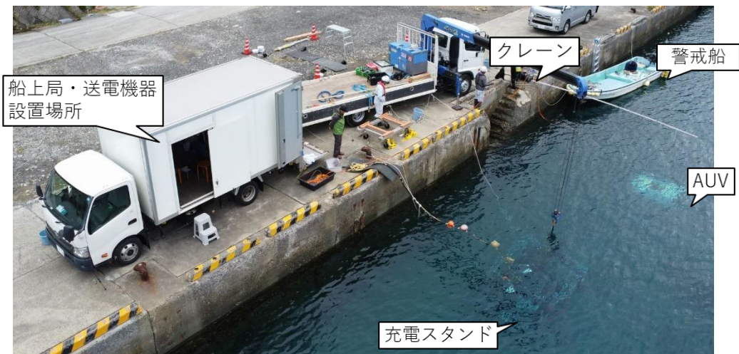
図 3.4-332 AUV 実海域充電実験の陸上側機器および車両の配置状況
