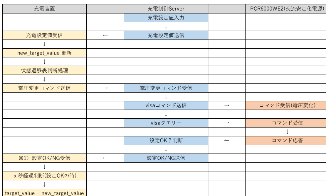
図 3.4-94 送電制御ダイアグラム(上昇方向)
