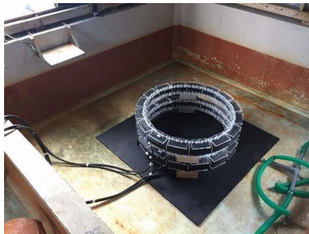
図 3.6-38 送受電コイルを配置した様子（海水注入前）
