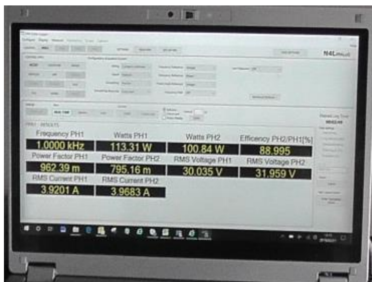
図 3.6-11 海水中で 100 W 伝送中のパワーアナライザ画面表示
