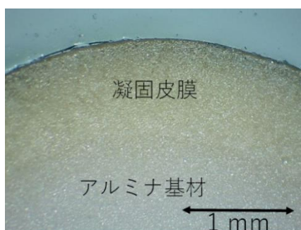
図 123 400 mm/h の移動速度で作製した試料の断面
