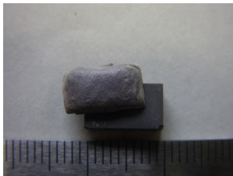
図 199 SmAlO 3 を中間層として成膜した試料の外観(雰囲気：Ar、基材：複合材)
