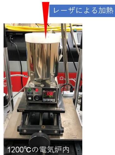
図 119 レーザ加工機を応用した成膜方法
