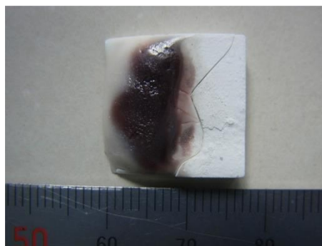
図 136 プラズマ加熱法を応用した表面塗布物の溶融実験
