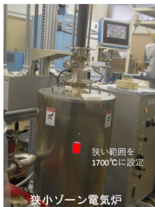
図 117 狭小ゾーン電気炉
