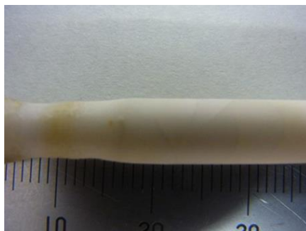
図 121 5,000 mm/h で熔融域を移動させて得られた凝固試料の拡大図
