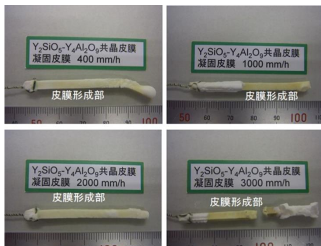
図 130 Y_2SiO_5-YAlO_3 共晶組成皮膜の作製
