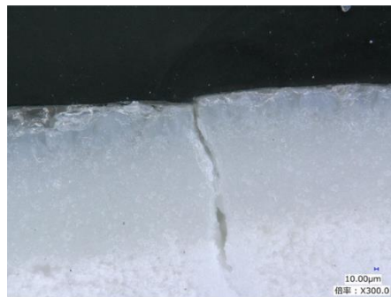
図 140 \text{LaAl}_{11}\text{O}_{18}/\text{La}_2\text{Hf}_2\text{O}_7/\text{LaAlO}_3 共晶皮膜断面クラック発生部 (1300°C)
