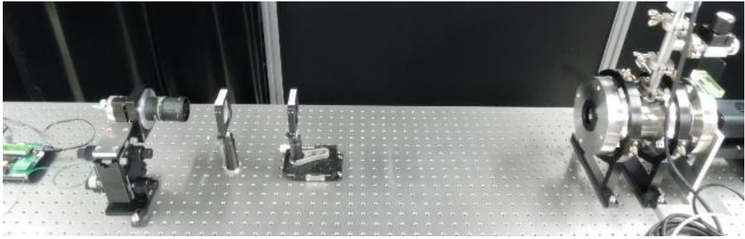
図 2.2.3-2 波面センサ(供試体)単体試験 試験写真
