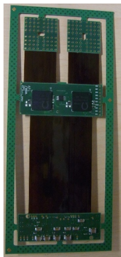
図 2.5-6 アナログデジタル変換ボード(1枚、128ch分)(左)とその動作試験セットアップ(右)
