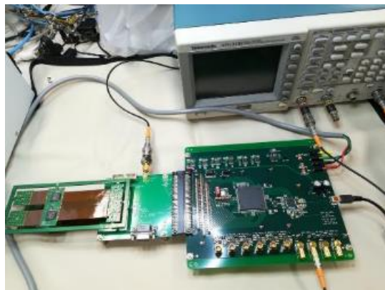
図 2.5-6 アナログデジタル変換ボード(1枚、128ch分)(左)とその動作試験セットアップ(右)
