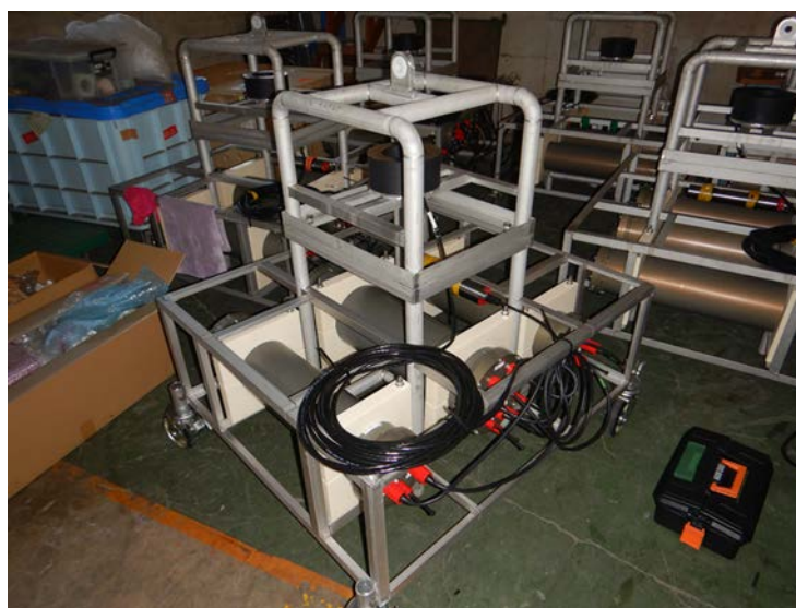
図 3.12 係留系で用いる送信装置及び係留フレーム
