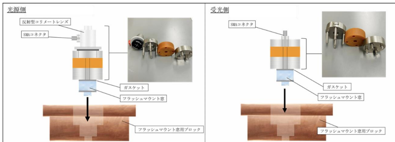
図3-1-3-2 供試体に組み込むシャドウグラフ光学系コンポーネント
