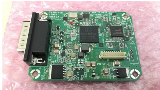
図3-1-3-15 試作した画像分割機(TVSD-4ch)
