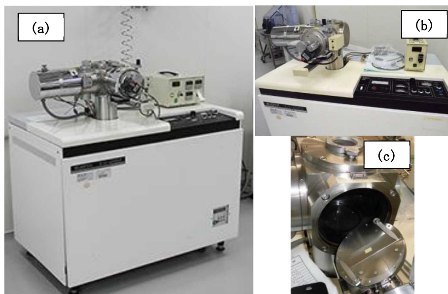
図 3.2.2 香川大学イオンシャワー装置 (EIS-200ER)。 (a) 装置全体図 (b) 装置上部図 (c) 装置への試料導入
