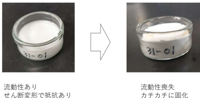
図 43. 高温での保持により流動性を失ったイオン液体ダイラタンシー材料の写真
