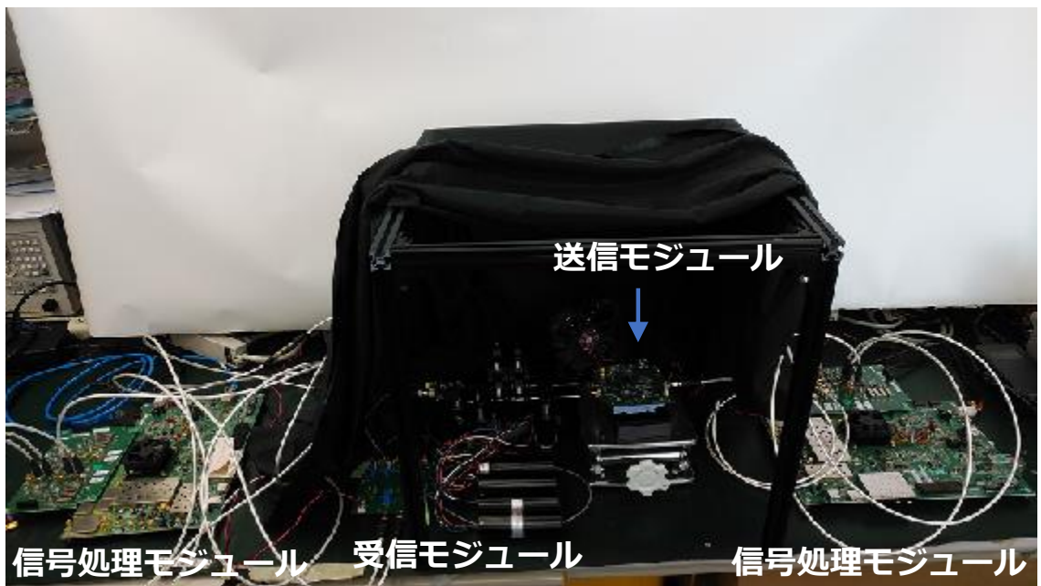
図2-c-4 送信，受信，信号処理モジュール結合試験系
