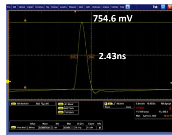
光パルス受信装置出力波形（488nm）
