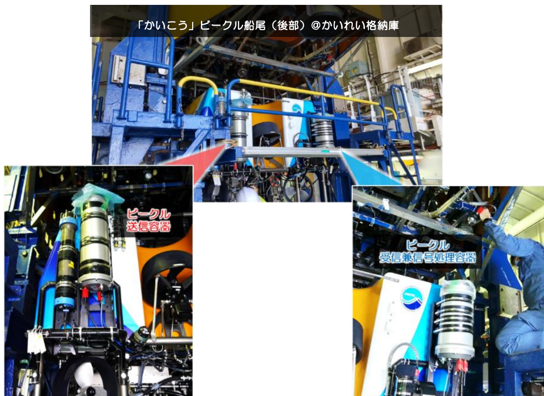
図 2-d-13 接続試験+機器搭載 | ビーグル搭載用機器 | (深海試験前事前作業)
