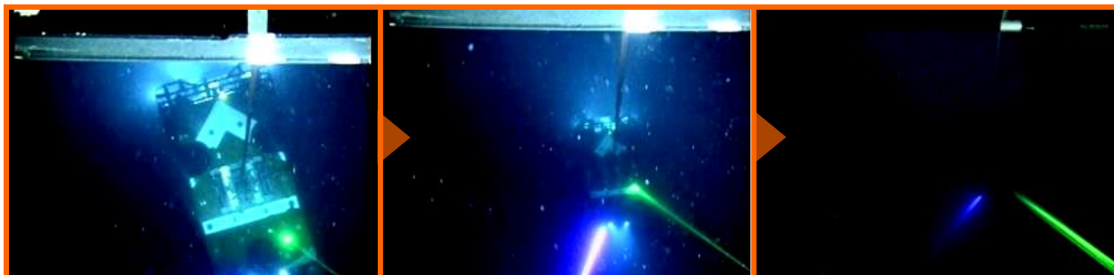
【下方カメラ映像 | ランチャー装備】 ビーグルがランチャーから離れ徐々に潜航していく様子
