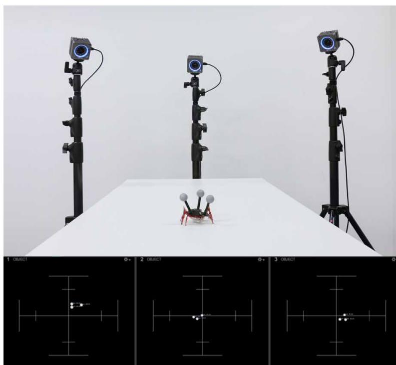
図 3.6.4-4 カメラがとらえたマーカーの2値化された反射光
