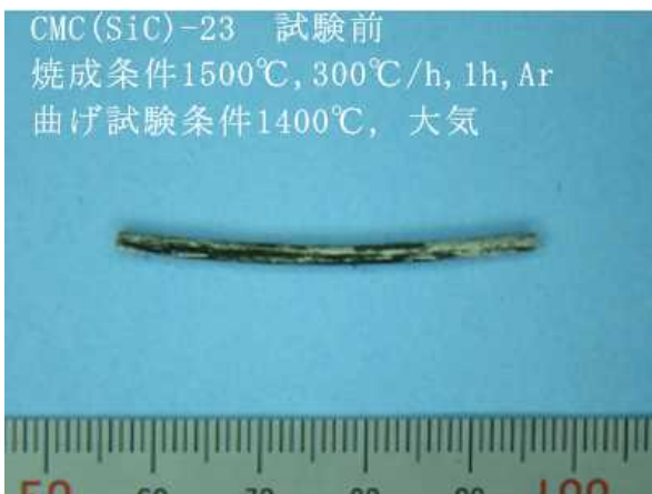
図 63 1400°Cあるいは 1500°Cまで 300°C/h で焼成した 1D-CMC(SiC)の 1400°C高温曲げ試験前後の外観
