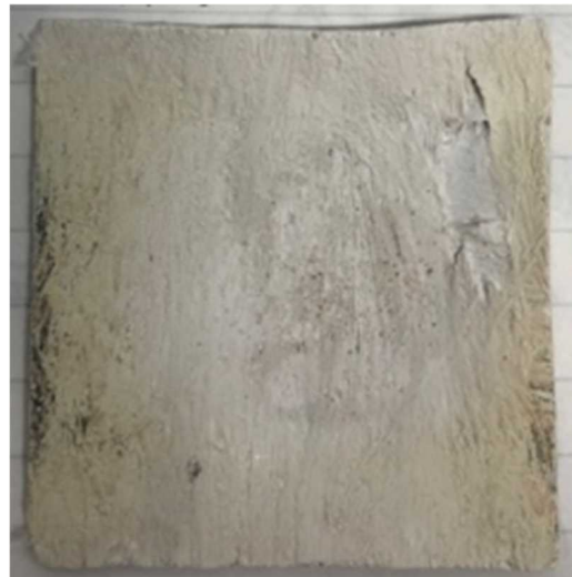
図 68 JAXA 装置による 1000°C 焼成 2D-CMC のエロージョン試験前後の試料外観写真
