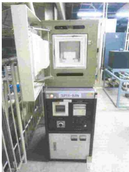
図51 3点曲げ試験の試験機外観と室温および高温試験条件
