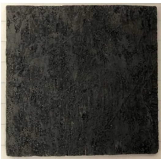
図 68 JAXA 装置による 1000°C 焼成 2D-CMC のエロージョン試験前後の試料外観写真
