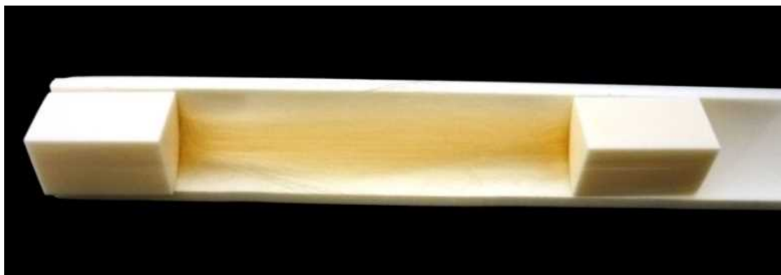
図25 繊維束の両端にアルミナ製の錘を載せた張力下での熱処理法
