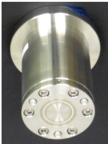
図22 製作した120 \mu mのノズル径のマルチホール紡糸用50Hノズル
