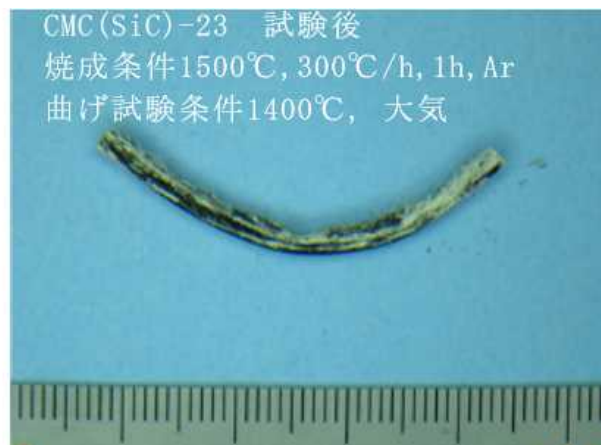
図 63 1400°Cあるいは 1500°Cまで 300°C/h で焼成した 1D-CMC(SiC)の 1400°C高温曲げ試験前後の外観
