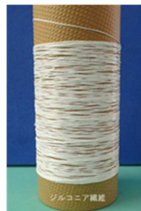
適用が期待されるニチビの水系乾式紡糸により試作されたジルコニア連続繊維
