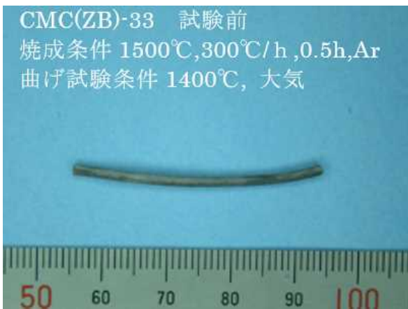
1500°C、300°C/h で焼成した供試体
