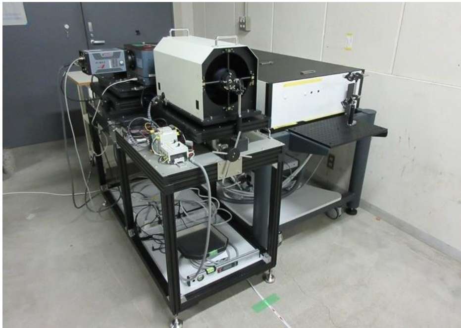
図 407 可搬型小型深紫外レーザー光源を搭載した小型微量有害物質共鳴ラマン計測装置
