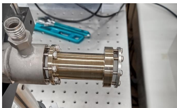
図 100 DMMP 気体の紫外吸収スペクトル計測実験系（セル窓部分）
