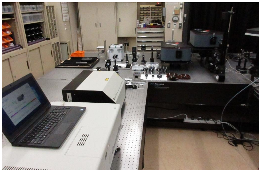
図 10 共鳴ラマンスペクトル計測装置の外観①
