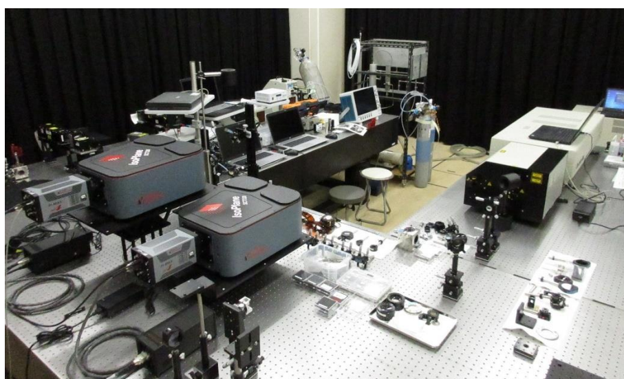
図 11 共鳴ラマンスペクトル計測装置の外観②
