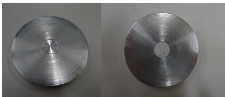
図 86 アセフェート固体 RRS 計測用アルミプレート (左)プレートのみ、(右)アセフェート充填後
