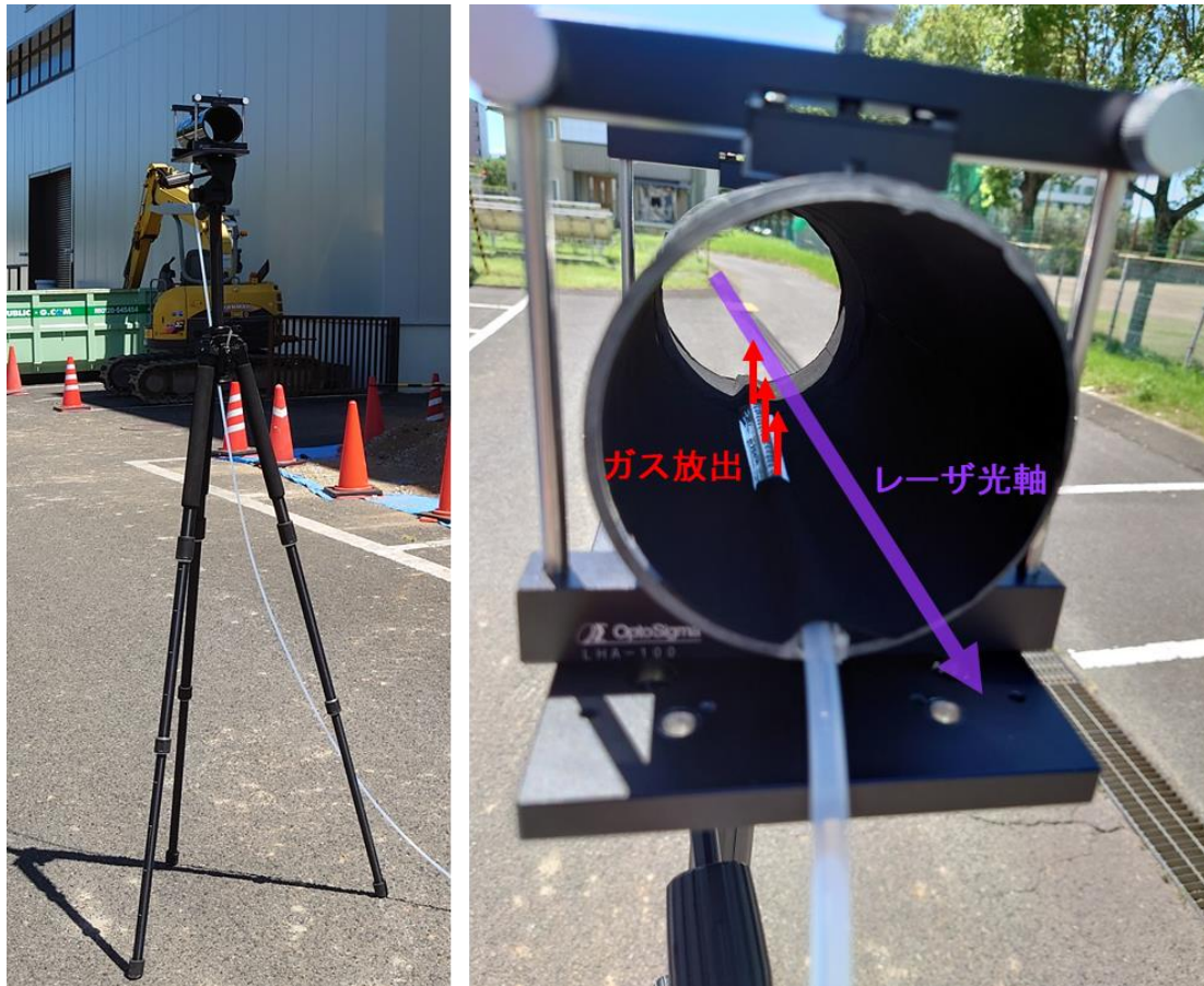
図 310 サンプルガス放出系の外観(右)全体、(左)放出口付近
