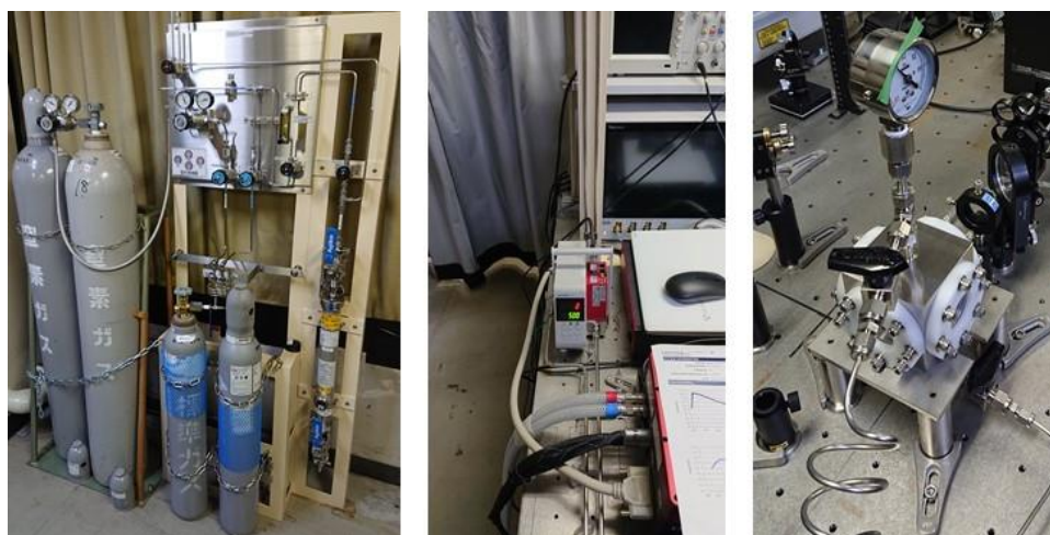
図 268 SO 2 ガスフローライン (左) ガス配管部、(中) 流量計、(右) ガスセル部
