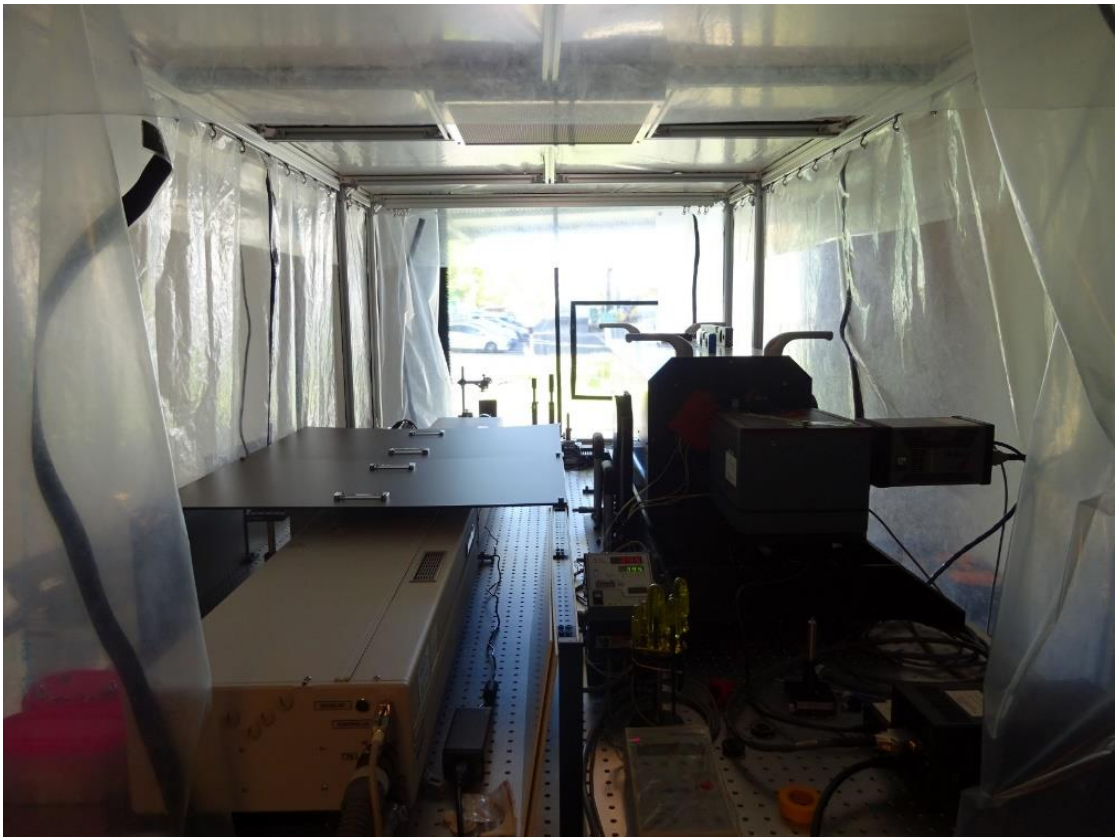
図 305 構築中のフィールド試験用共鳴ラマンライダシステム(上)正面、(下)背面
