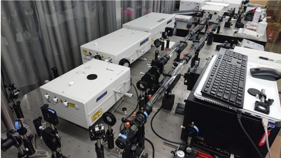
図 388 波長可変 Ti:S レーザの SRS パルス圧縮実験の (上)光学配置のブロック図、(下)外観
