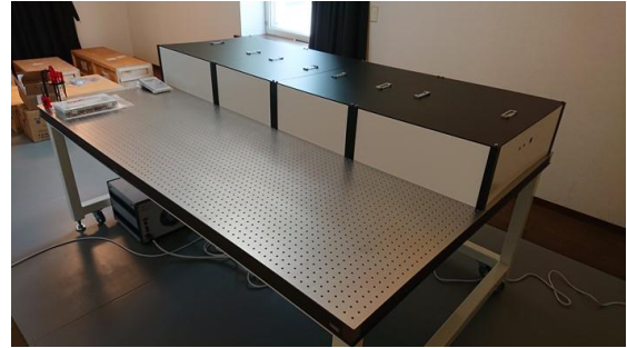
図 409 遠隔ライダ実証試験での高出力深紫外波長可変レーザー光源の設置
