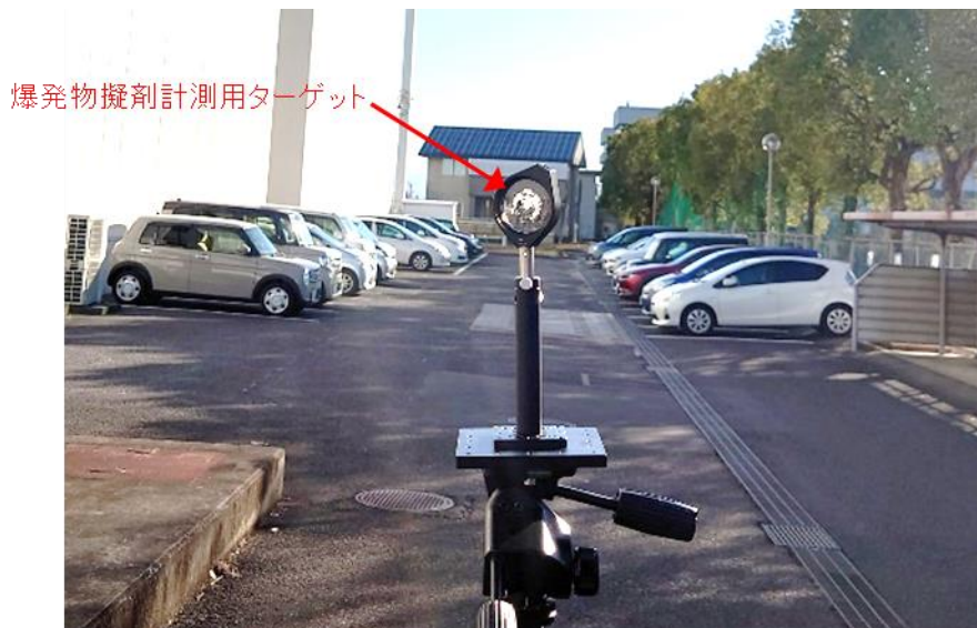
図 325 爆発物擬剤の計測用ターゲット設置状況
