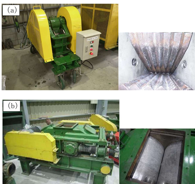
図①-1-4 粉碎試験に供した装置の外観および粉碎部拡大 (a) ジョークラッシャー、(b) ロールクラッシャー
