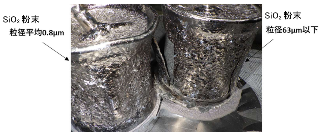
図②-1-30 タービン翼模擬形状 HIP 後キャニング缶外観
