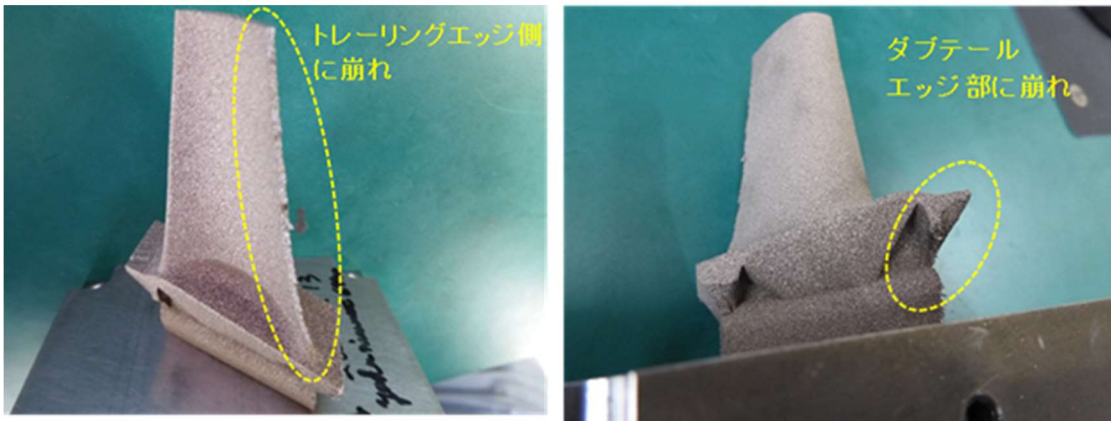
図②-1-20 タービン翼模擬形状 造形品外観
