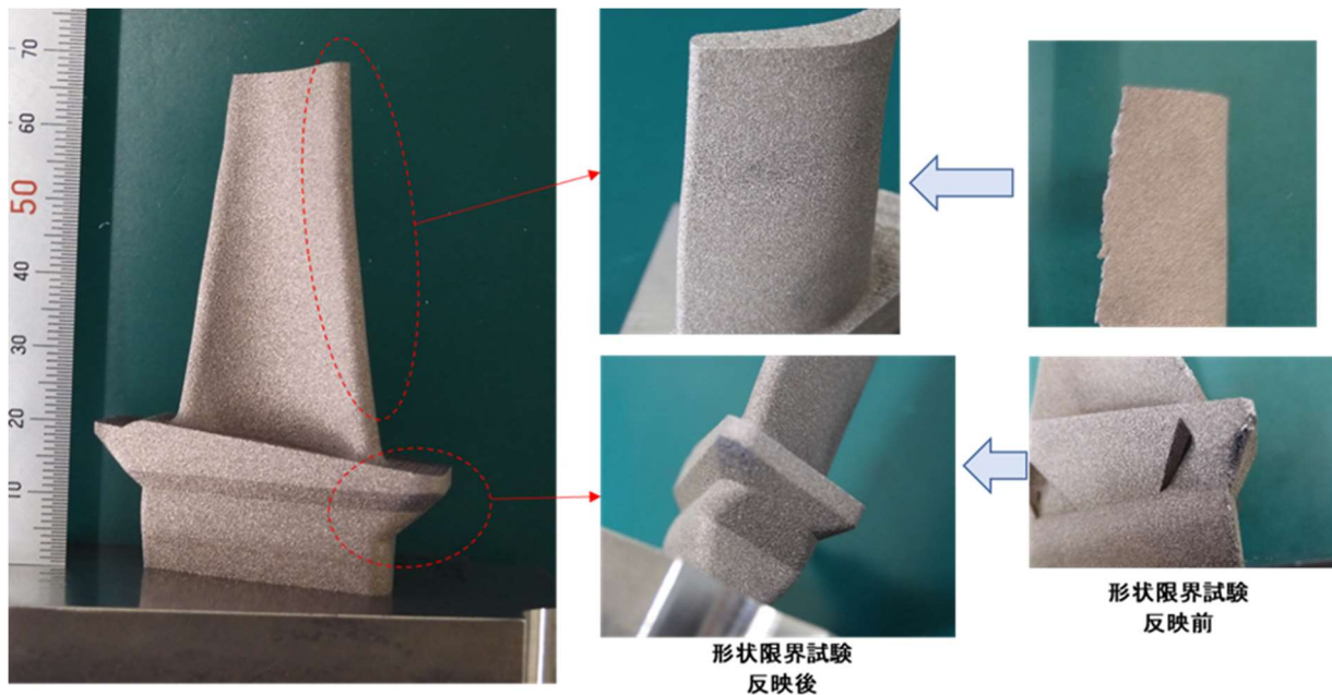
図②-1-2-3 オーバーハング形状限界試験結果反映後 タービン翼模擬形状造形体外観
