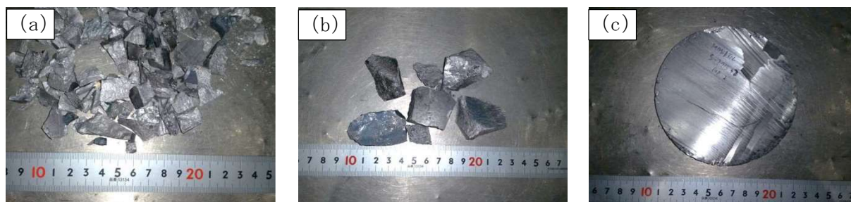
図①-1-5 インゴットから加工した粉碎試験用試料外観 (a) 小粒径、(b) 中粒径、(c) 板状試料
