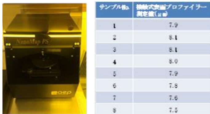
図 3.3.2.6 表面プロファイラと評価一例。
