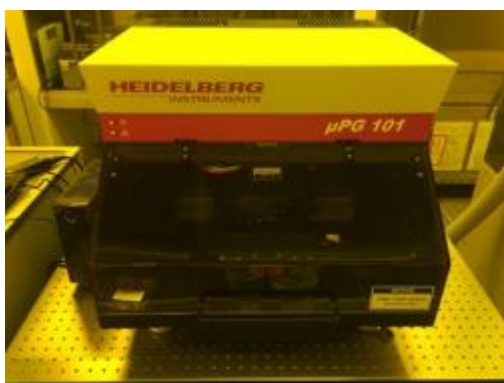
図 3. 3. 2. 7 レーザ露光機。
