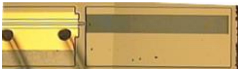
図 3.3.3.18 PC 評価用の端面発光型 QCL（左）と PC（右）の連結構造。 PC は正方格子に配置された直角 2 等辺三角柱が面積占有率で 45%となるように形成。
