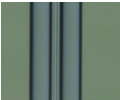
図 3.3.2.3 10\mu\text{m} 高さのリッジ上でオーミック電極用フォトソグラフィを行った素子の光学顕微鏡写真。
