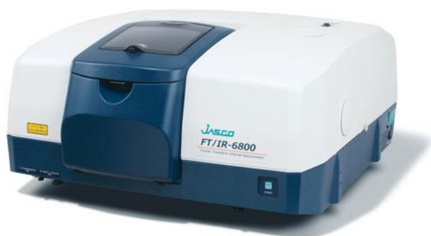
図 3.1.29 赤外分光光度計の外観。 中央が試料室。
