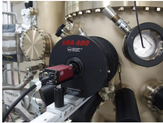
図 3.3.1.15 RHEED 画像評価装置の概観。蛍光面上の RHEED パターンをカメラにより輝度を数値化する。任意の領域の輝度を数値化できる。
