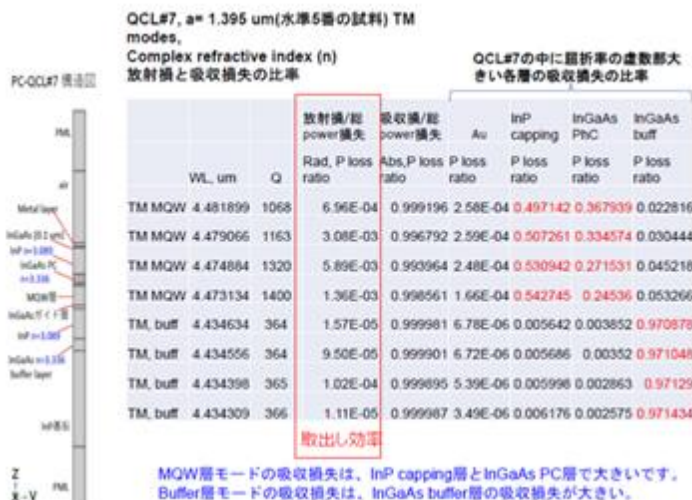
図 3.3.2.18 各層での光吸収損失の計算結果。
