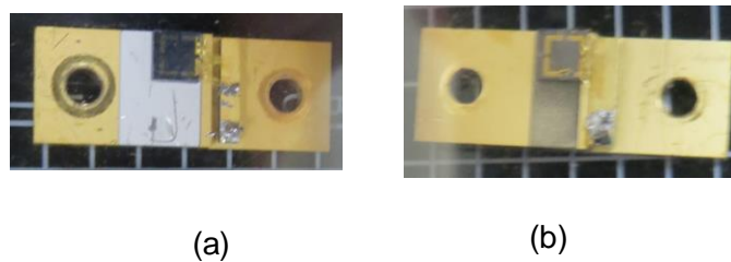
図 3.2.26 面発光型 QCL の外観写真 (a) InP 埋込み構造、(b) Au 埋込み構造
