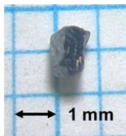
図1 高压フラックス法で育成した Gd_3Os_4Al_{12} 単結晶の外観
