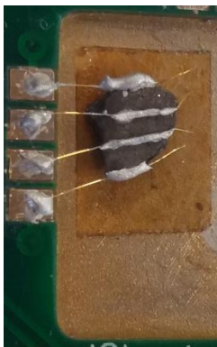
図2 \text{SmMnSb}_2 の焼結体の写真（電気抵抗率測定用の金細線を装着している）。
