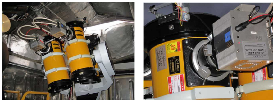
図1: 豪州 Siding Spring 天文台内遠隔観測施設に設置された4連望遠鏡及びCMOSセンサー
