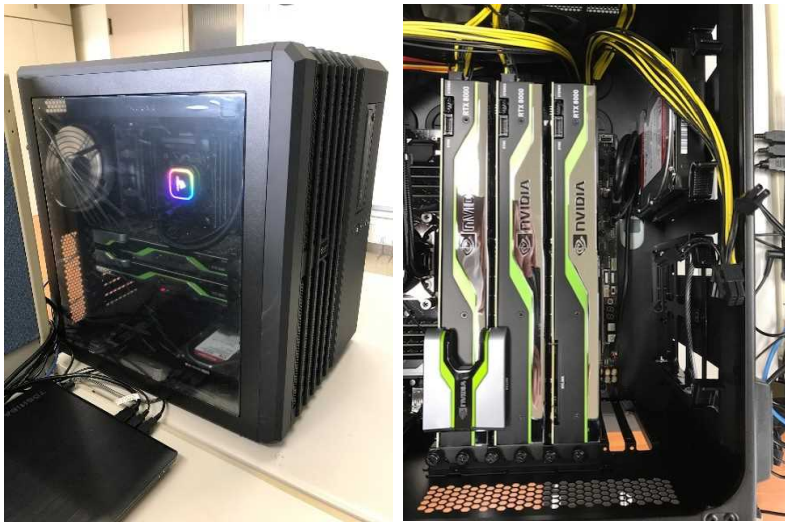
図 7: 本研究において開発されたジューデップ・アドバンス社製 GPGPU マシン。GPU ボードとして NVIDIA Quadro RTX8000 を 3 枚搭載 (右図)。
