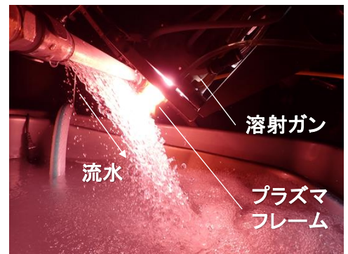
図22 プラズマ溶射による50Y 2 O 3 -50MgO組成物の急凝固試験。
