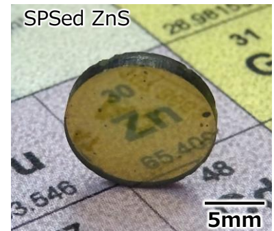
図53 高荷重 (200MPa) で通電焼結したZnS多結晶体。
