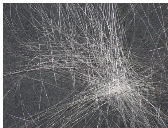
図5 78\text{Al}_2\text{O}_3\text{-}22\text{Gd}_2\text{O}_3 組成物の急凝固繊維。
