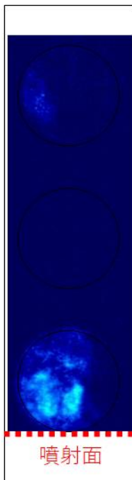
図 3-2-9 コンフィギュレーション a_総流量 489g/s_当量比 0.41 全体的に弓なりの形状とみられる。波面形状も当量比 1.00 付近と比べると鮮明ではない。
