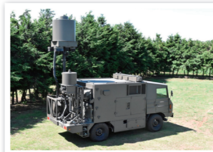
Équipement de guerre électronique en réseau neutralisant les radars et communications de l'adversaire
